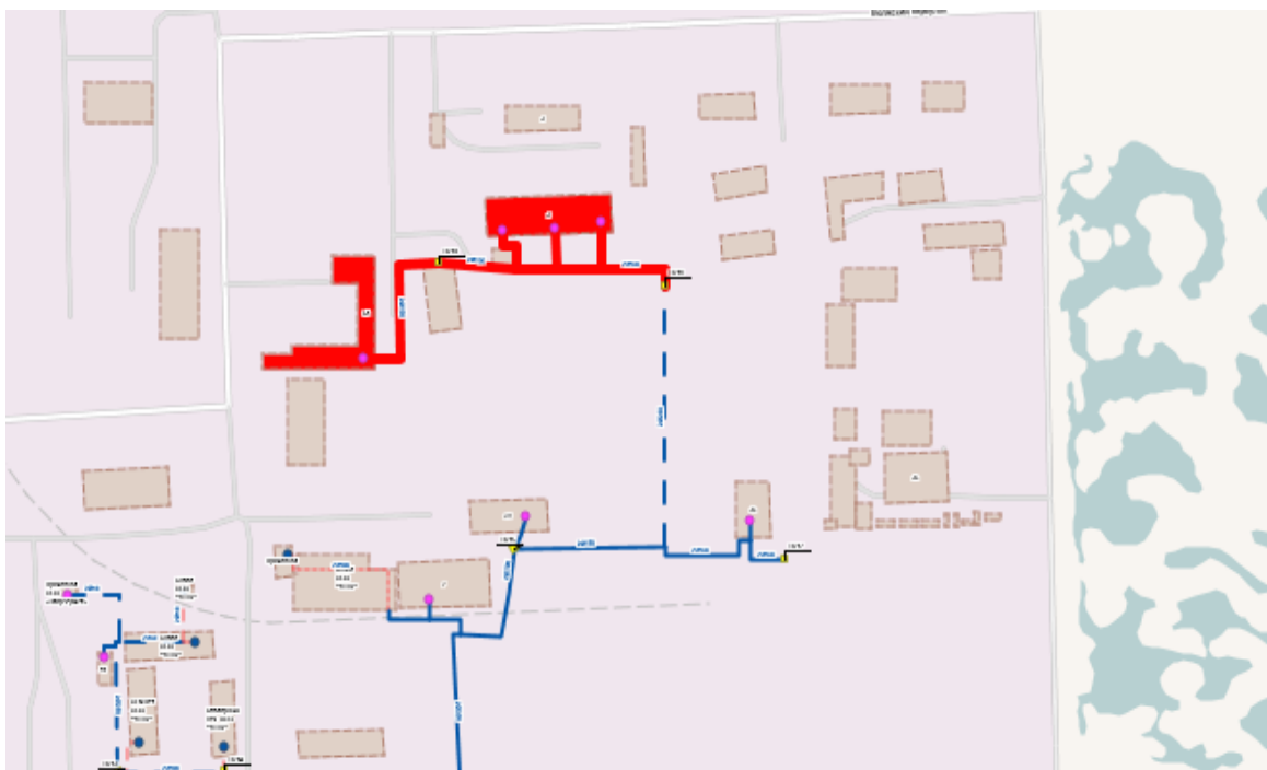
Рисунок 39. Визуализация отключения запорной арматуры ТК-18-Уз.151 (котельная УПТК)
