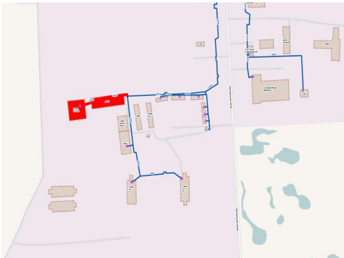
Рисунок 38. Визуализация отключения запорной арматуры 17ТУ-21-Уз.441 (котельная СУ-78)
