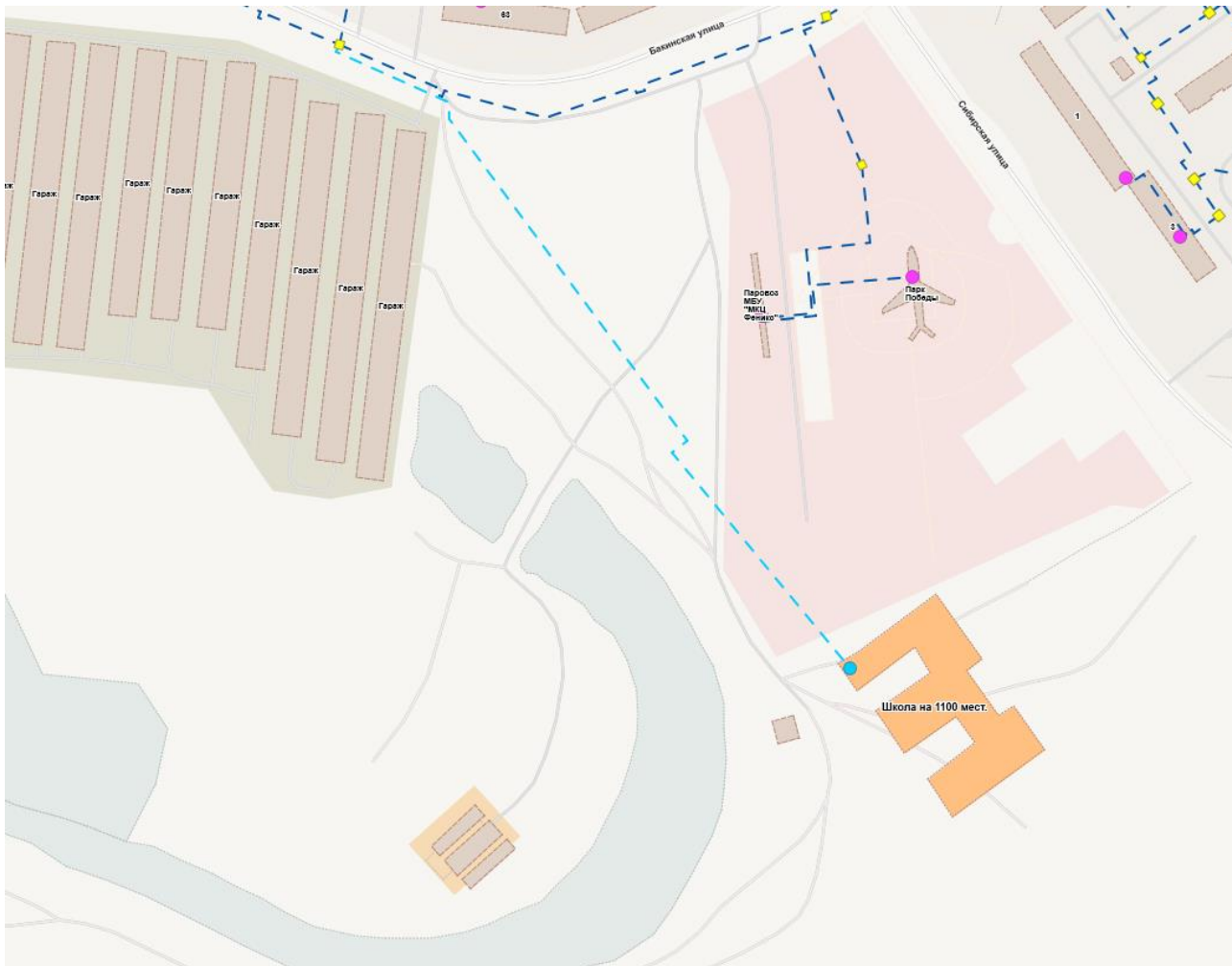
Рисунок 17. Схема подключения перспективного потребителя «Школа на 1100 мест»
