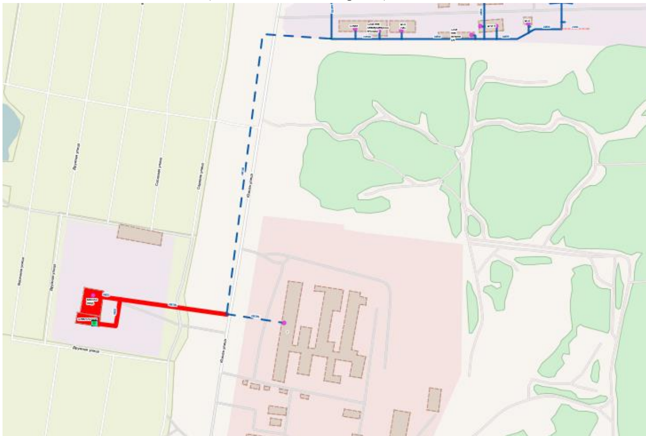
Рисунок 35. Визуализация отключения запорной арматуры Уз.79-ТК-3 (котельная КОС)
