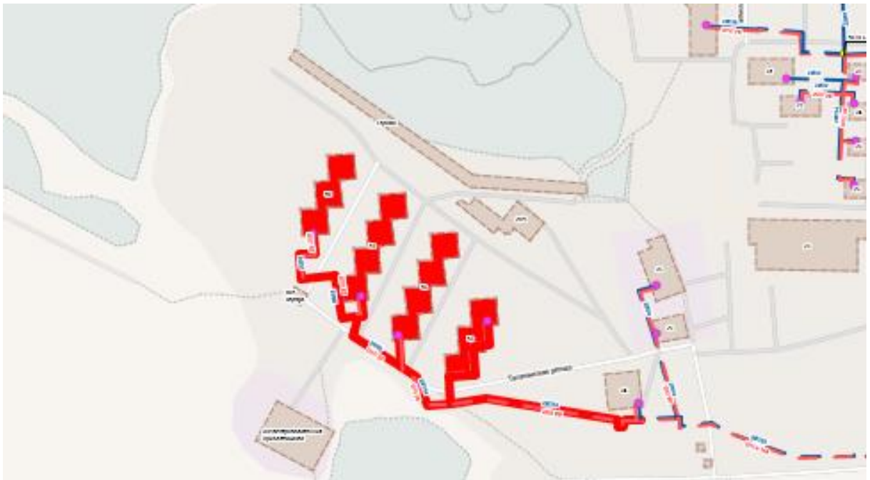
Рисунок 37. Визуализация отключения запорной арматуры Уз.564-19УТ-70 (Котельная ПМК-177)
